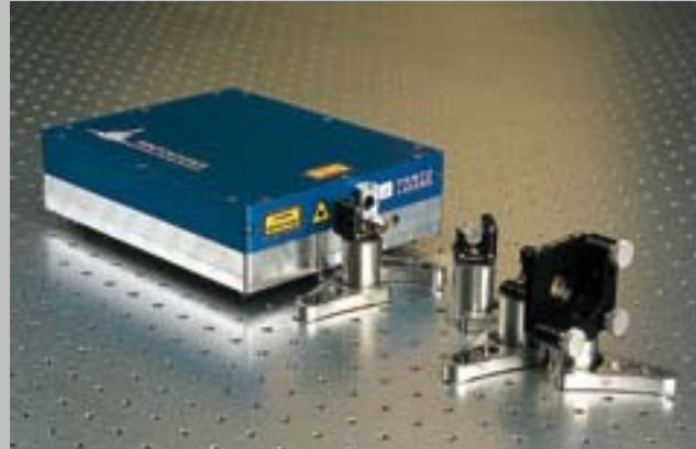
fs-Oszillator (800 nm, <12 fs): sub- \mu m-Strukturierung geplant: Nachverstärkung
