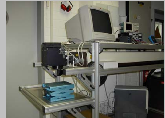
Nd:YAG-Laser mit Scanneroptik (Q-Sw. 100 ns, 532 nm): Laserformabtrag und Beschriftung
