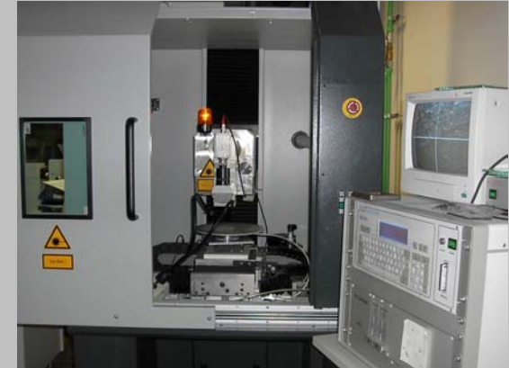
Nd:YAG-Bearbeitungsstation (cw, Q-Sw. 100 ns, 1064 nm): Mikrobohren, Feinschneiden Kunststoffschweißen
