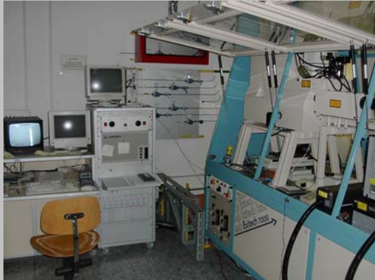
Excimerlaser-Workstation (193 nm, 17 ns): UV-Mikro- strukturierung, Laser-LIGA
