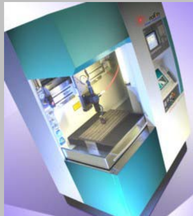
Nd:YAG-Bearbeitungsstation (gepulst, 1 ms, 1064 nm): Metallschweißen
