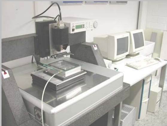
Diodenlaserschweißanlage (Barren 976 nm, cw): Kunststoffschweißen
