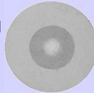
1 mm POF PMMA-SI/DSI 100 Mbit · 100m
