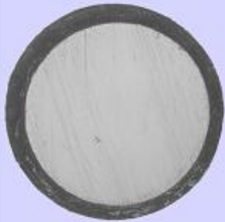
1 mm POF PMMA-SI/DSI 100 Mbit · 100m
